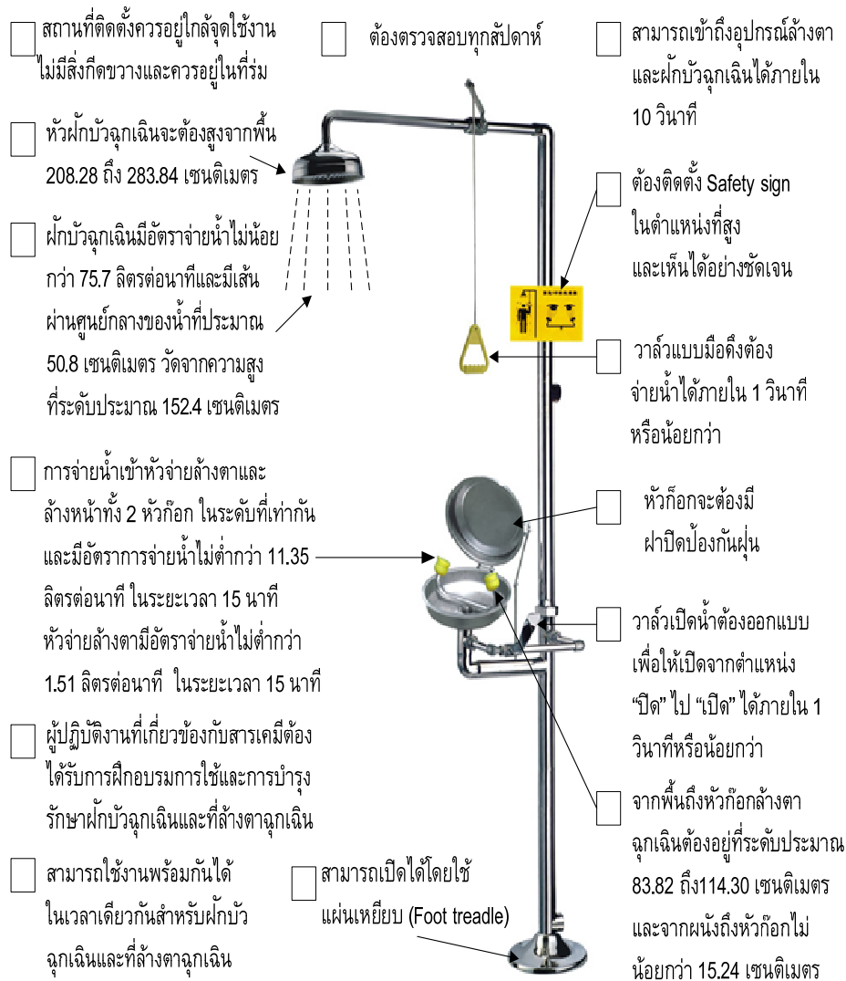
รูปที่ 7-1 ฝักบัวฉุกเฉินและที่ล้างตาฉุกเฉิน (Emergency shower and emergency eye wash)
