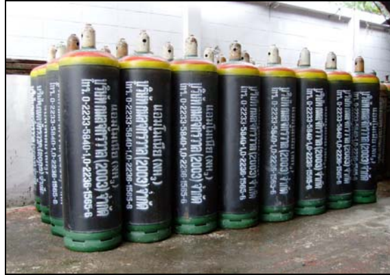
รูปที่ 3-6 ตัวอย่างท่อบรรจุขนาดเล็กชนิดมีฝาครอบวาล์ว
