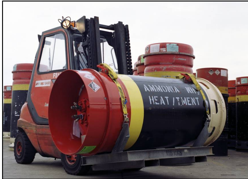
รูปที่ 5-2 การขนย้ายถังบรรจุแอมโมเนียขนาดใหญ่
