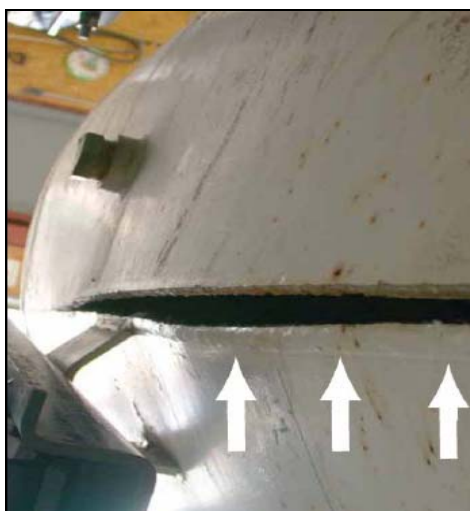
รูปที่ 2 รอยแตกที่แนวเชื่อมใต้แท็งก์บรรจุก๊าซแอมโมเนีย
