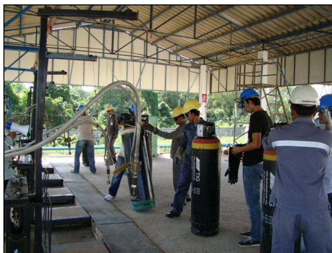
รูปที่ 5-4 การเติมก๊าซแอมโมเนียลงท่อบรรจุ
