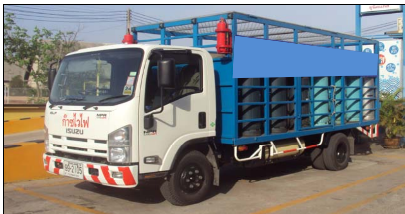
รูปที่ 5-6 ตัวอย่างรถขนส่งท่อบรรจุแอมโมเนียที่มีตาข่ายปิดด้านบน
