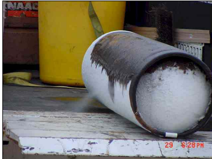
รูปที่ 6-3 การรั่วไหลด้านข้างถังบรรจุแอมโมเนีย
